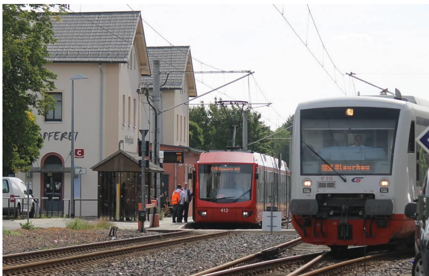
V jednom kolejišti stanice Stolberg se potkávají klasická městská tramvaj, která přijela z Chemnitz po železniční trati a LKV, která přijíždí jako vlak po železnici.
