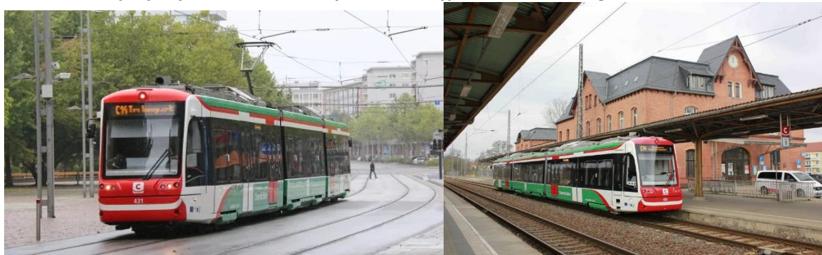
V Chemnitz na regionálních tratích vozidlo využívá spalovací motor.
