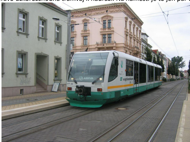
Pro Zwickau jsou lehká železniční vozidla vybavena osvětlením a směrovkami včetně brzdových světel stejně jako silniční vozidla.
