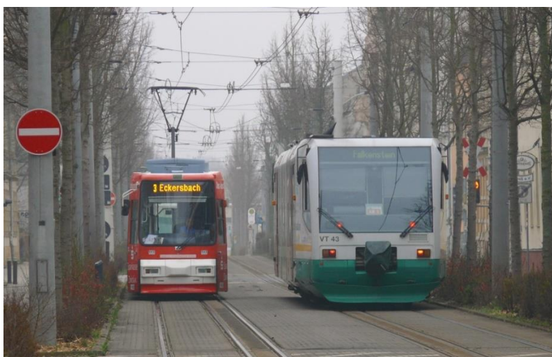
Rozdíl mezi lehkým kolejovým vozidlem a tramvají. Pro rozhodování, zda LKV nebo tramvaj je na tomto obrázku dobře patrný rozdíl velikosti skříně.
